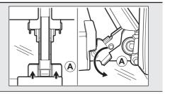
Schritt 3 Schliessen Sie die Ofentür bis zur ersten Öffnungsstellung (Winkel ca. 70 Grad). Fassen Sie die Tür auf beiden Seiten und ziehen Sie sie schräg nach oben vom Ofen weg. Legen Sie die Tür mit der Aussenseite nach unten auf ein weiches Tuch und eine stabile Fläche.
