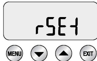
Die Maschine fordert Sie anschließend zur Einstellung der Wasserhärte auf. Ihre Wasserhärte mithilfe der Pfeiltaste nach oben (UP) oder unten (DOWN) einstellen, anschließend MENU drücken, um die Einstellung zu bestätigen, oder EXIT, um in den STANDBY-Modus zurückzukehren.
