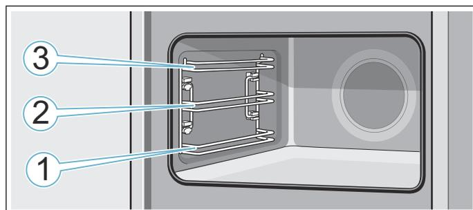
In den Einschubhöhen 1, 2, und 3 das Zubehör immer zwischen die beiden Führungsstäbe einer Einschubhöhe schieben.
