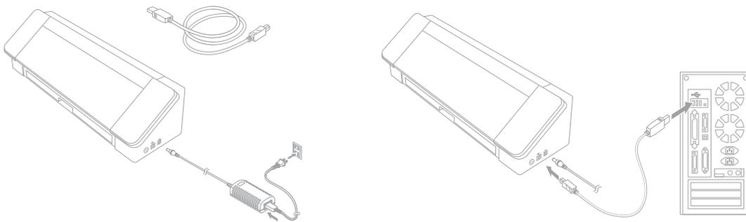
Connectez ensuite votre machine à votre ordinateur à l'aide du câble USB. Allumez ensuite votre machine en appuyant sur l'interrupteur de mise sous tension.
