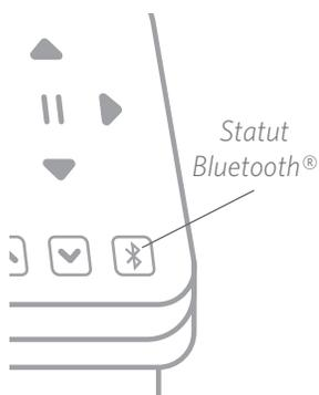
Le Silhouette Cameo® 4 est compatible avec Bluetooth® et permet une communication sans fil. Vous pouvez ainsi envoyer des designs d'un appareil Bluetooth® compatible avec votre Cameo 4 afin de les découper sans que votre machine ne soit connectée à votre ordinateur.
