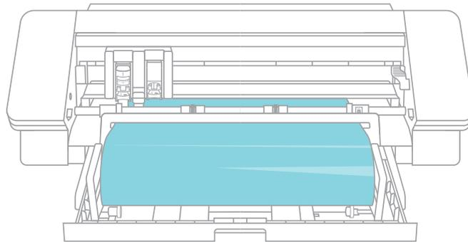
Lorsque vous avez terminé d'utiliser le chargeur du rouleau, retirez le rouleau de matériau, repliez les pièces et remettez le bac en place.
