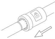
Tout en maintenant le bouton de verrouillage enfoncé, faites glisser le rouleau dans la position souhaitée. Relâchez le bouton sur le corps du rouleau et verrouillez le levier de dégagement en le tournant dans le sens contraire des aiguilles d'une montre.
