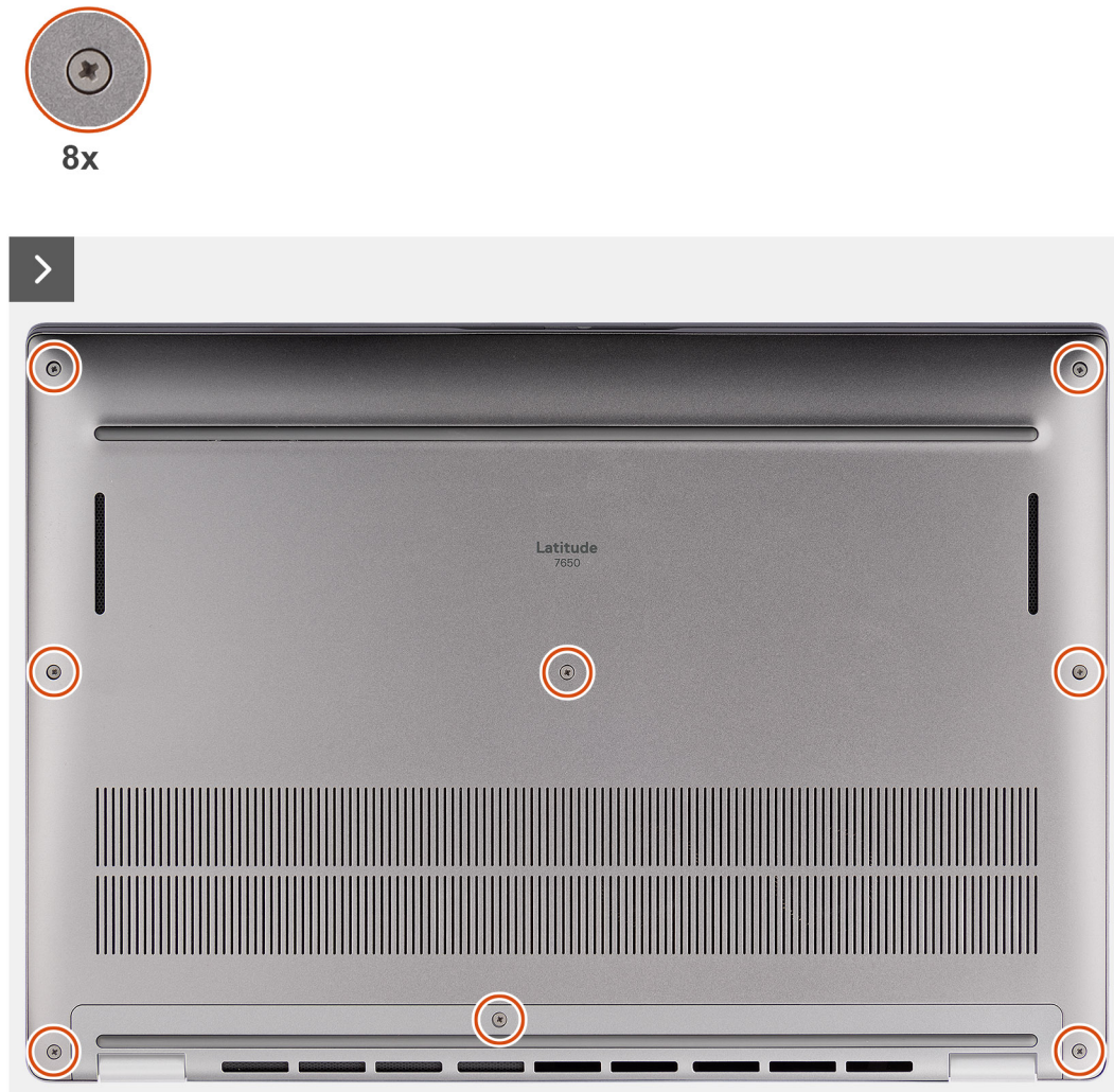
Abbildung 12. Entfernen der Bodenabdeckung
