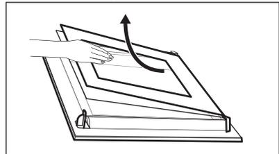
9. Reinigen Sie die Glasscheibe mit Wasser und Seife. Trocknen Sie die Glasscheibe sorgfältig ab. Führen Sie nach Abschluss der Reinigung die obigen Schritte in umgekehrter Reihenfolge durch. Setzen Sie zuerst die kleinere Scheibe ein, dann die grössere Scheibe und die Tür.
