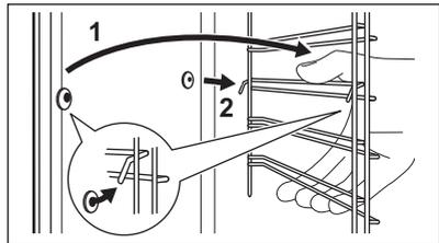
Führen Sie zum Einsetzen der Zubehörteile die oben aufgeführten Schritte in umgekehrter Reihenfolge durch.
