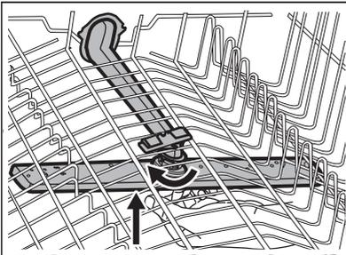
3. Reinigen Sie den Sprüharm unter fließendem Wasser. Entfernen Sie
