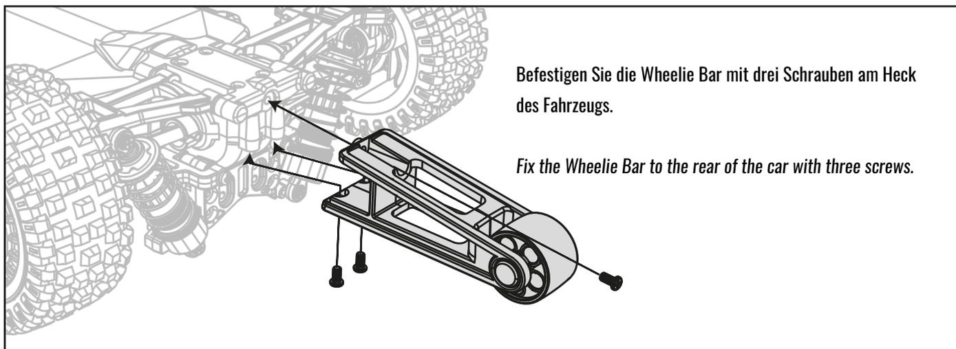
Befestigen Sie die Wheelie Bar mit drei Schrauben am Heck des Fahrzeugs.
