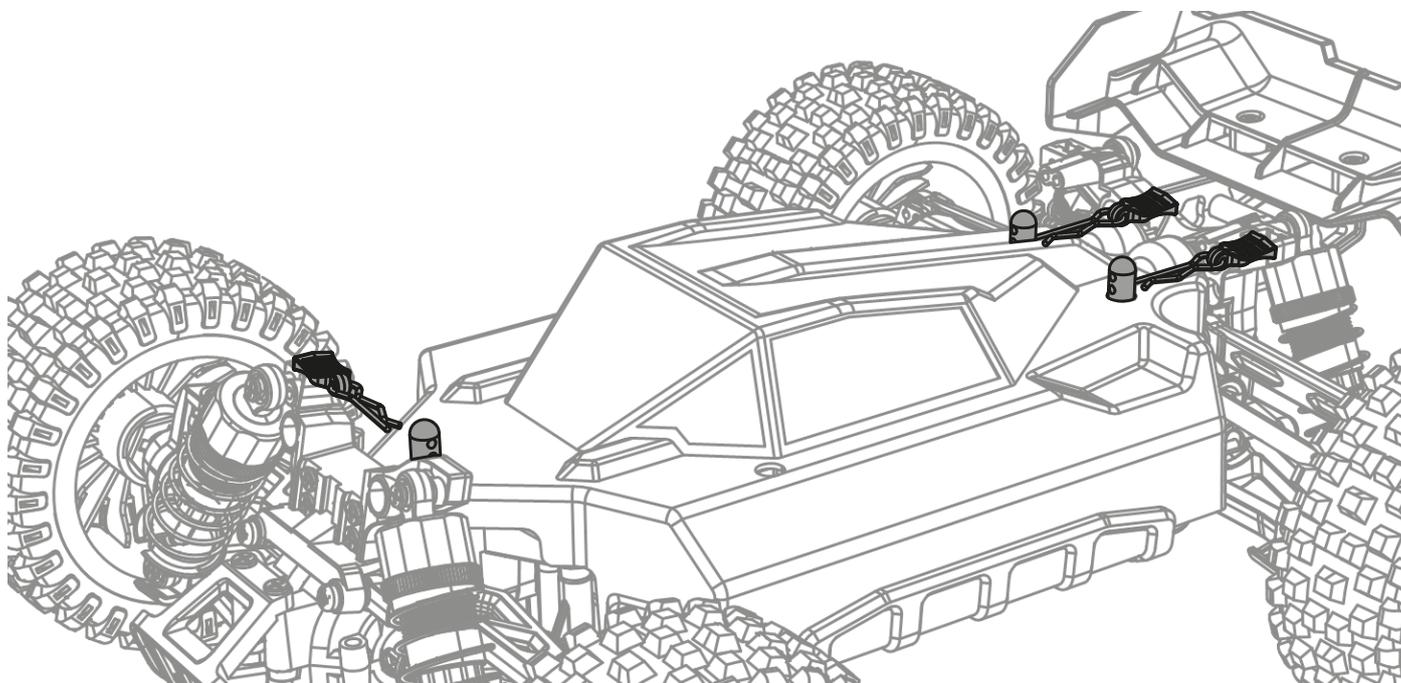
Stecken Sie die drei Clips in die Löcher der Karosseriehalterung, um die Karosserie zu verriegeln.
