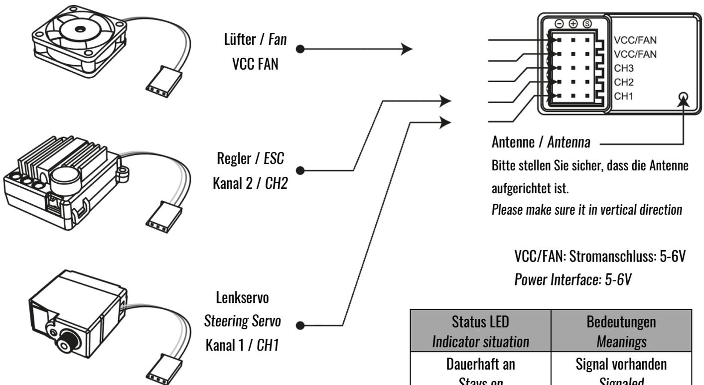
Warnung: stellen Sie sicher, dass alle Anschlüsse korrekt verbunden sind.
