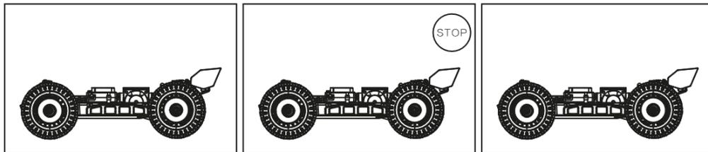
**Bremsen:** Wenn das Auto vorwärtsfährt, ziehen Sie den Gashebel zurück, bremst das Fahrzeug. Lassen Sie den Gashebel los und ziehen Sie ihn erneut zurück, das Auto fährt rückwärts.
