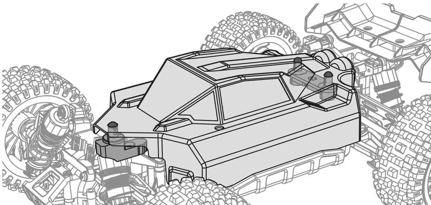
Richten Sie die 3 Löcher der Karosserie mit den Haltern aus und drücken Sie sie dann nach unten.
