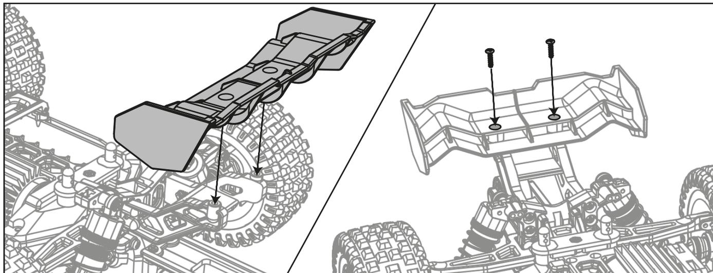
Befestigen Sie den Heckflügel an der Halterung mit zwei Schrauben.
