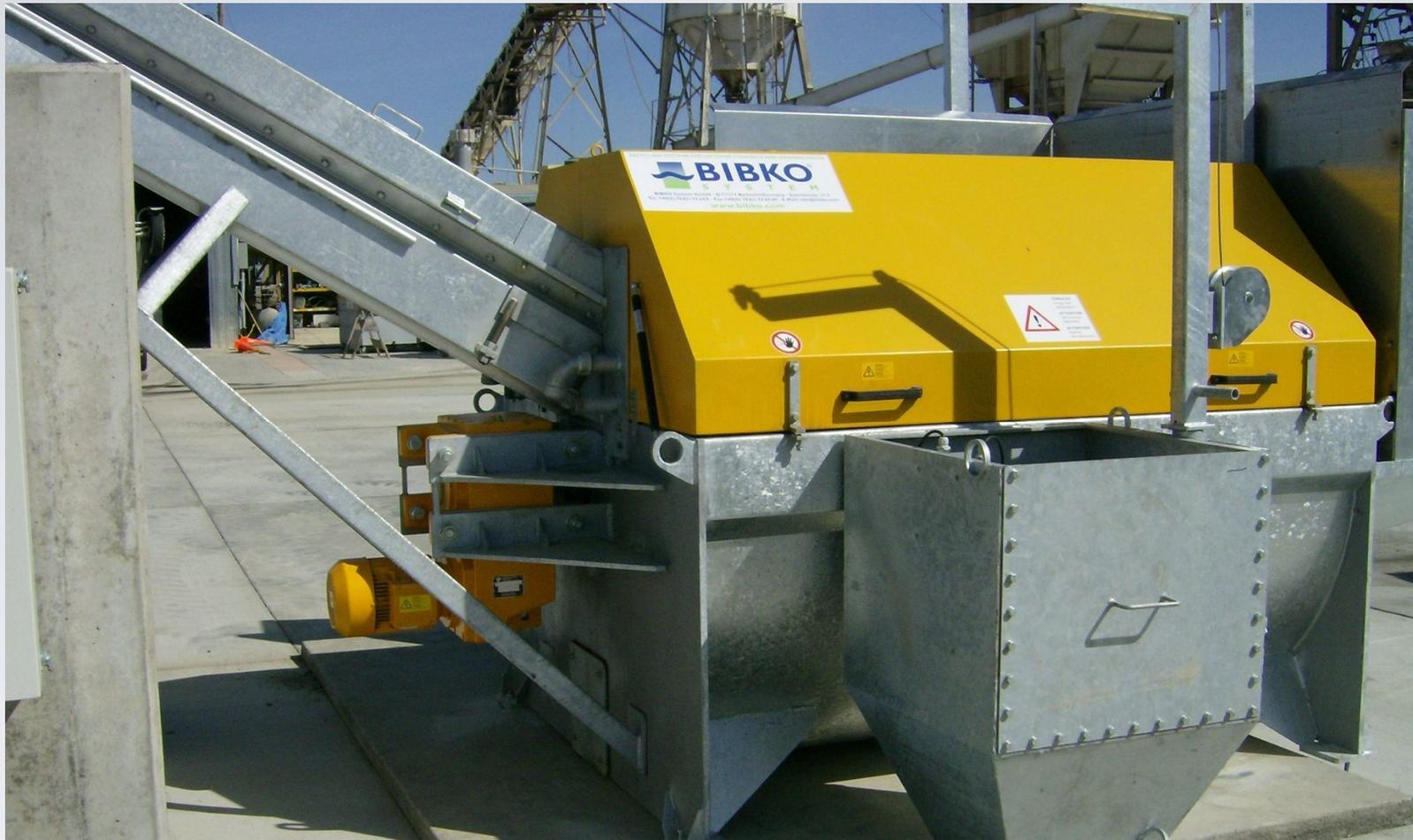
BIBKO MOTOR, GEAR BOX AND BEARINGS ARE AWAY FROM SLURRY
