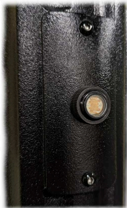
Button Photocell On Door (PCD)
