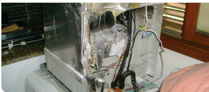
Incêndio parcial em uma secadora de roupas
