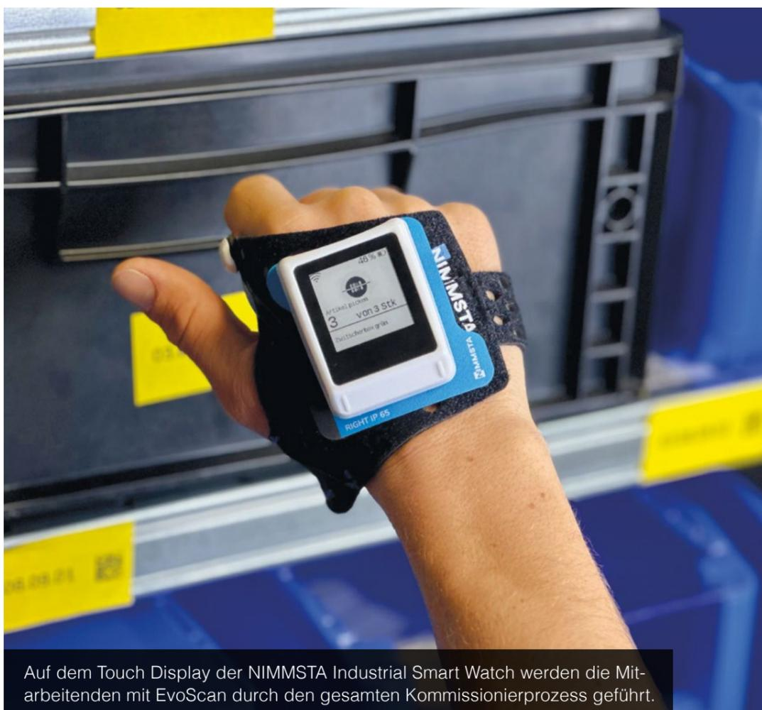
Auf dem Touch Display der NIMMSTA Industrial Smart Watch werden die Mitarbeitenden mit EvoScan durch den gesamten Kommissionierprozess geführt.
