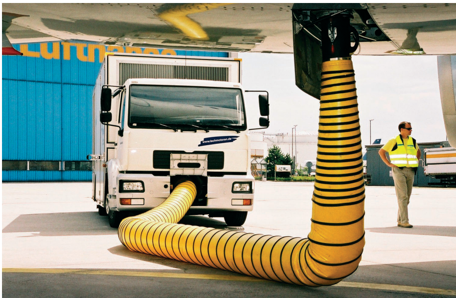
Das mobile Klimasystem bei der Kühlung eines Airbus A340 am Frankfurter Flughafen
