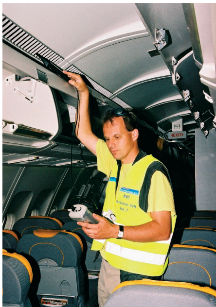
Überprüfung der Luftaustrittstemperatur im Inneren des Flugzeugs durch Steffen Klein, Combitherm
