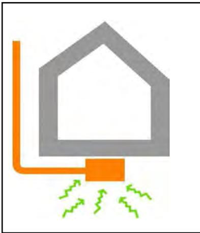
Figura 13: depressione del sottosuolo tramite pozzetto.
