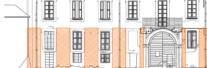
ciclo A - opere provvisoriali puntellamento della facciata nord
