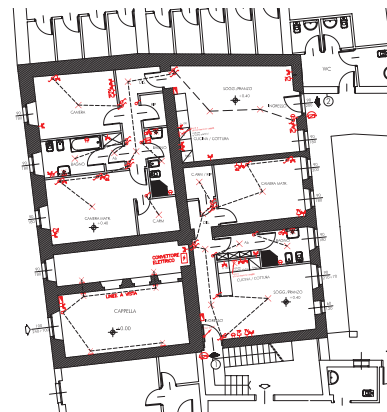
schema impianti elettrici - piano terra
