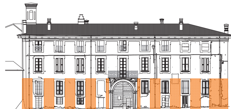
ciclo A - opere provvisoriali puntellamento della facciata nord
