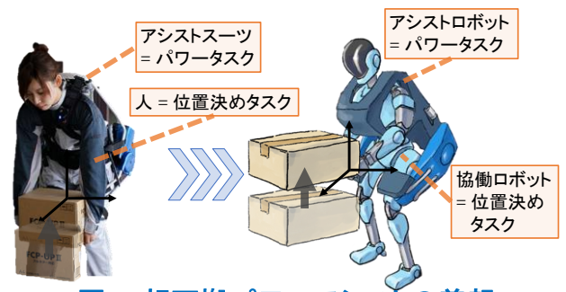
図2 超可搬パワーアシストの着想
