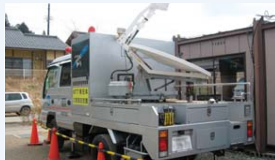
NTT東日本の無料公衆電話回線用エントランス局（陸前高田市）
