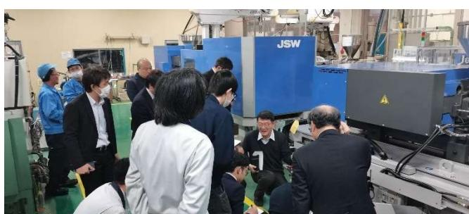
対象設備は、プラスチック射出成形機（日本製鋼所製）、成形品自動取出機（セーラー万年筆ロボット機器事業部製）等、それぞれ装置の情報をリアルタイムで収集、送信する「IoTユニット」が組み込まれています。
