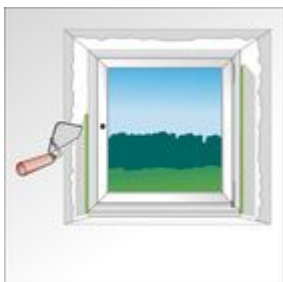
Afb. 8 Kozijn rondom afwerken met pleister.
