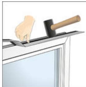
Afb. 9 Het geschikte profiel met rubberhamer aanbrengen.
