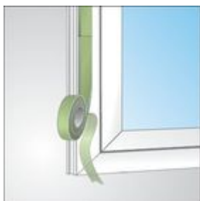
Hoek aansluiting bij de kozijnmontage
