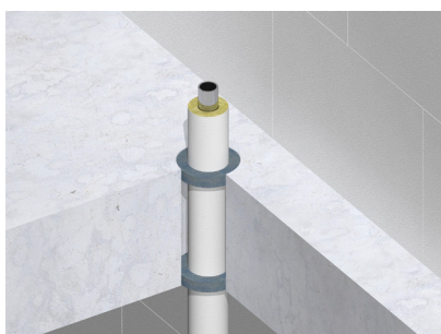
Metalen buizen voorzien van glaswol isolatie
