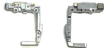
Pad thermique du module mmWave
