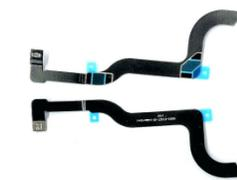
Adhésif conducteur sensible à la pression 1 pour circuit flexible du module mmWave
