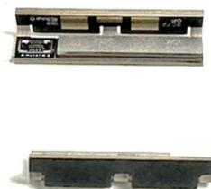
**Circuit flexible du module mmWave**
