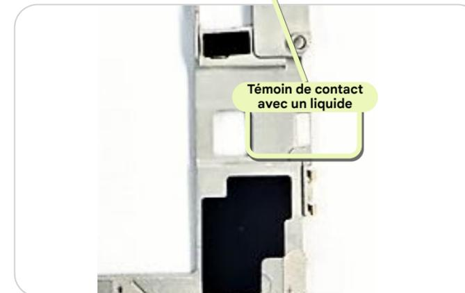
Dans le tiroir de la carte SIM, sur la structure centrale (visible sans démonter l'appareil)
