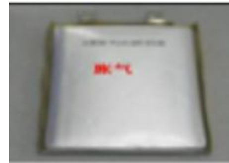
Gonflement ou fuite d'électrolyte (dégagement d'une forte odeur)
