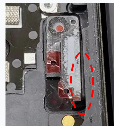
Mauvaise installation : écart
