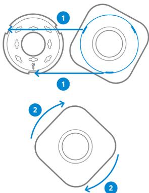
**Tip:** Als het nodig is de melders los te koppelen (om hem schoon te maken of de batterijen te vervangen), draai je de melders linksom totdat hij loskomt van de montagesteun.
