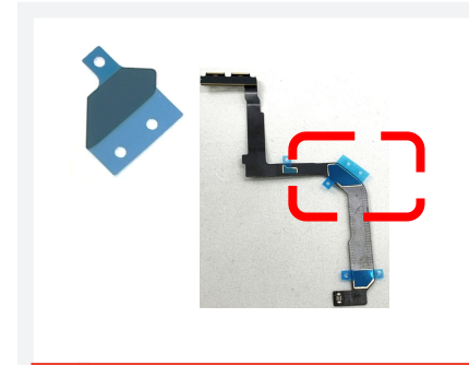
Adhésif conducteur sensible à la pression 2 pour circuit flexible de module mmWave G806-07335-01
