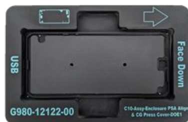
Plaque de presse adhésive sensible à la pression pour boîtier, avec alignement de la vitre avant G980-12122-00
