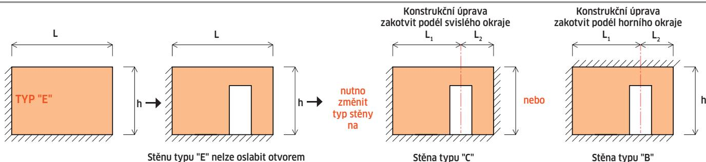
Na stěnu typu „E“ oslabenou otvorem se tato tabulka nevztahuje, je potřebné stěnu ještě podepřít buď při volném svislém okraji a tak změnit na stěnu typu „C“ oslabenou otvorem nebo stěnu podepřít při horním okraji a změnit ji na stěnu typu „B“ oslabenou otvorem.
