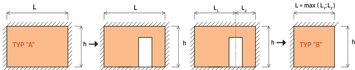
Typ stěny „A“ oslabené otvorem se uvažuje jako u typu stěny „B“, kde za délku stěny L se považuje větší z délek  $L_1$  a  $L_2$  (větší vzdálenost od líce stěny do osy otvoru). Celková délka stěny  $L = L_1 + L_2$  je omezena max. délkou jako u stěny typu „A“ (bez oslabení).
