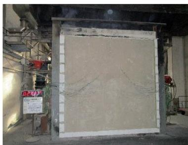
Zkouška požární odolnosti stěny.
