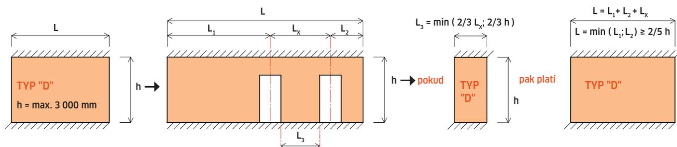
Pokud jde o stěnu typu „D“ (max. výška stěny  $h = 3,00$  m) oslabenou více otvory, pak tabulka mezních rozměrů stěn platí pro její levou, pravou a střední část, pokud je splněna podmínka, že délka stěny mezi otvory  $L_3$  je větší než  $2/3$  délky  $L_x$  od osy otvoru k ose otvoru a současně musí být větší než  $2/3$  výšky stěny (konkrétně pro otvory šířky  $800$  mm při výšce příčky  $3000$  mm to odpovídá minimální délce stěny mezi otvory  $L_3 = 2000$  mm).
