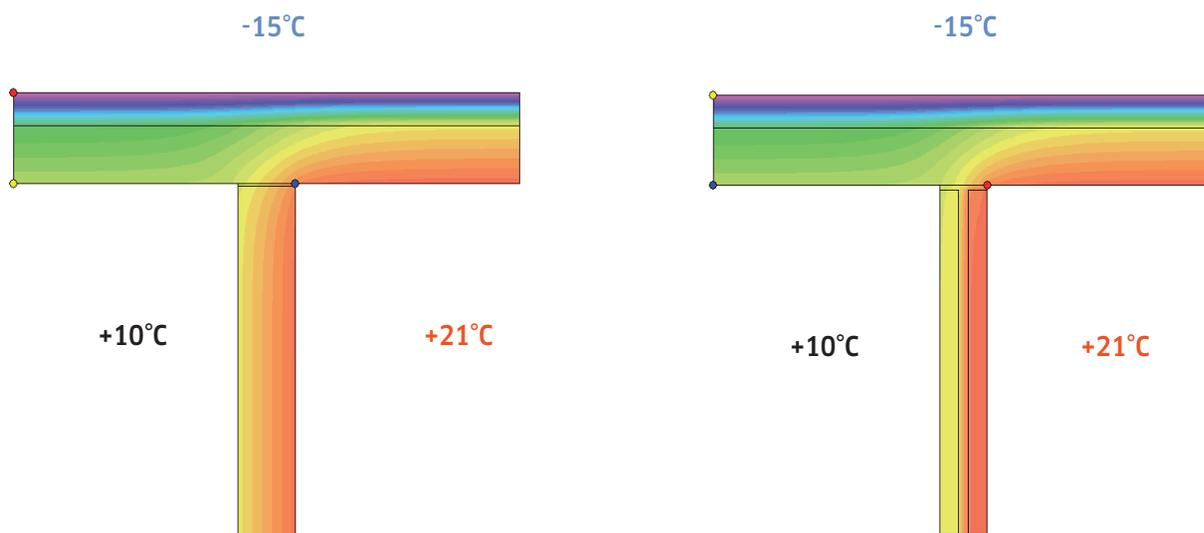
Povrchové teploty dělicí stěny z cihel tradičních AKU cihel jsou nižší a tepelný tok stěnou je větší.
