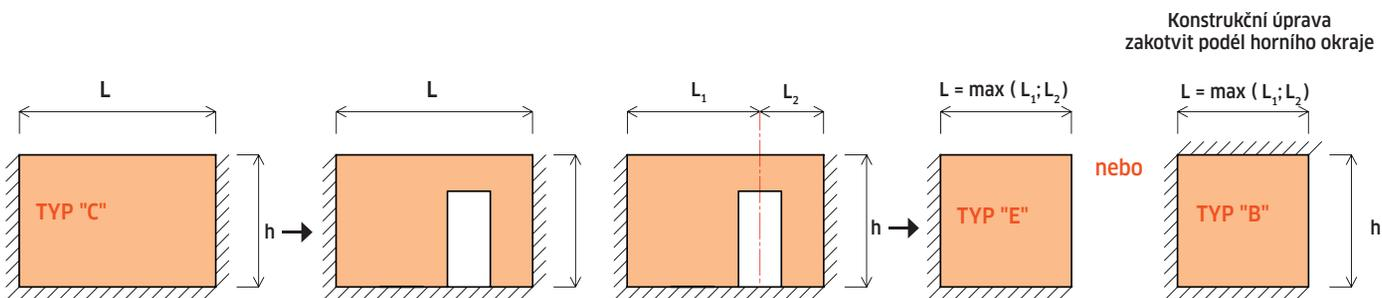
Stěnu typu „C“ oslabenou otvorem je možné uvažovat jako stěnu typu „E“ kde za délku stěny L se považuje větší z délek  $L_1$  a  $L_2$ . Pokud při tomto posouzení stěna nevyhoví, je třeba stěnu podepřít také při horním okraji a pak ji lze uvažovat jako stěnu typu „B“, kde za délku stěny L se považuje větší z délek  $L_1$  a  $L_2$  a současně musí platit, že celková délka stěny  $L = L_1 + L_2$  je omezena max. délkou jako u stěny typu „A“ (bez oslabení).
