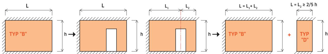
Stěna typu „B“ oslabená otvorem je omezena max. výškou stěny  $h = 3,0$  m. Stěna se posoudí jako stěna typu „B“ celkové délky  $L = L_1 + L_2$  a současně stěna typu „D“ délky  $L_2$ , kdy musí být splněna podmínka, že min. délka  $L_2$  je větší než 2/5 výšky stěny (alter. 500 mm + 1/2 šířky otvoru).
