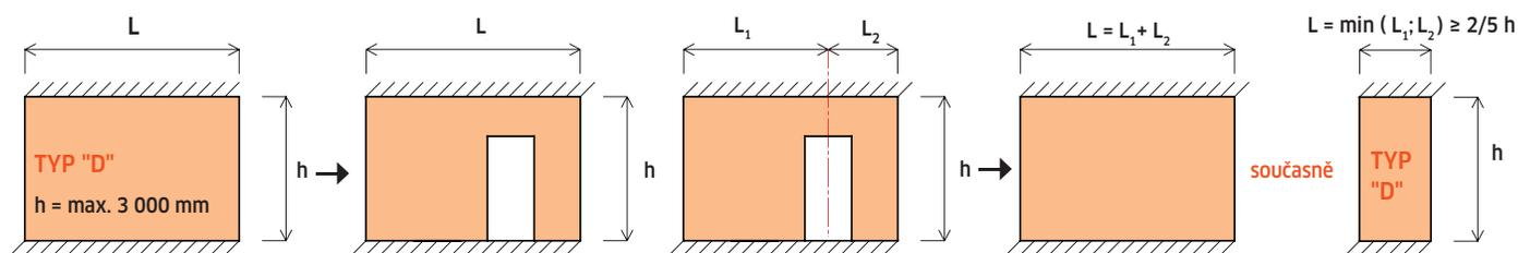
Pokud jde o stěnu typu „D“ (max. výška stěny  $h = 3,00$  m) oslabenou otvorem, pak celková délka stěny  $L$  je omezena délkou jako u stěny typu „A“ a současně je omezena také min. dílčí délkou stěny  $L_1, L_2$ , která musí být větší než  $2/5$  výšky stěny (alter.  $500$  mm +  $1/2$  šířky otvoru).
