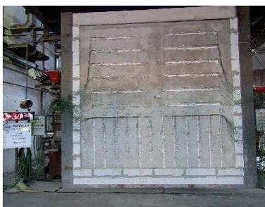
Zkouška požární odolnosti spár.
