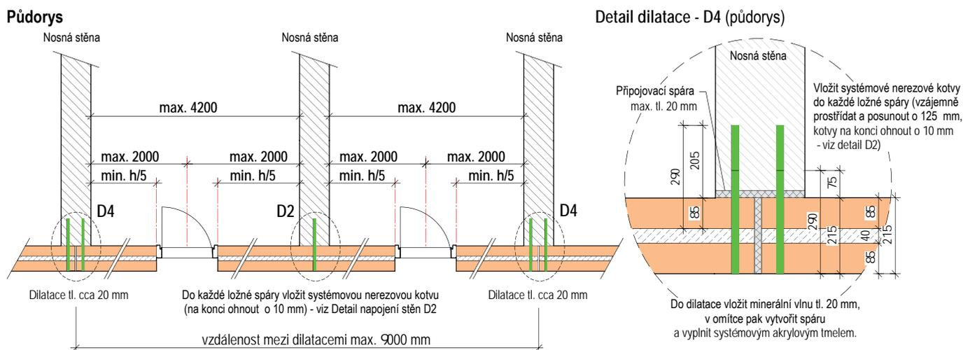
Pro zakotvení nenosné stěny AKU Kompakt 21 s nosnou stěnou postačí 1 kotva v ose nosné stěny (zakončení nosné stěny pak je považováno za „volný okraj“).
