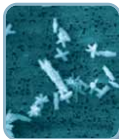
Kalkkrystaller behandlet med AMTech 100 ®
