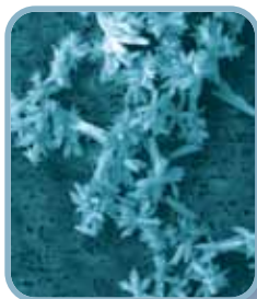
Kalkkrystaller sammenklynget i ubehandlet vand
