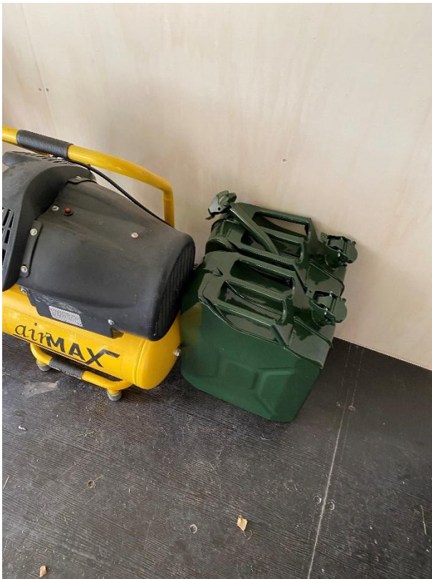
Oplag af diesel skal på spildbakke eller fjernes helt
