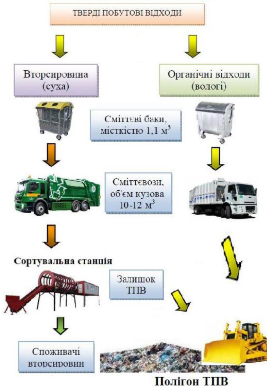
Рис. 2.1 Схема сортування ТПВ на 2 потоки
