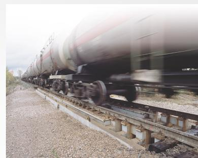
Надежность и уровень безопасности могут быть увеличены за счет дополнительных функций, встраиваемых в железнодорожную систему взвешивания Trapper, например, функций идентификации и описания вагонов. Возможность надежной привязки номеров вагонов к результатам взвешивания позволяет избежать ошибочной информации, причиной которой могут стать, например, неверно составленные поездные ведомости или вагоны, отцепляемые по пути следования.
