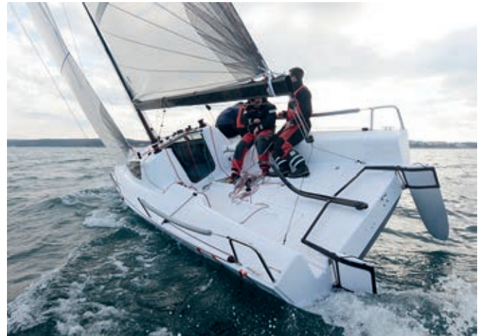
Mit der Doppelruderanlage bleibt das Boot auch bei starker Schräglage immer voll beherrschbar.
