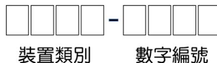
例如：PM-0001 表示”電表 0001”、PM-0002 表示”電表 0002”、CH-0100 表示”冰水主機 0100”。
