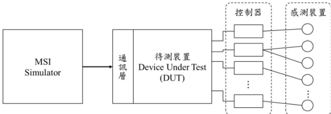
圖 6 智慧建築設施管理系統資料格式標準之測試架構方塊圖
