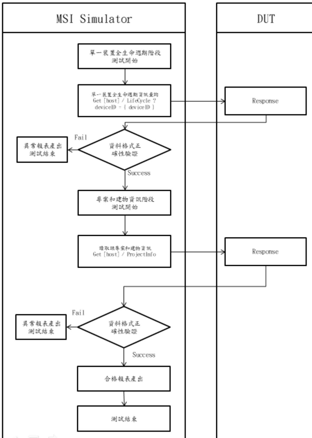
圖 7 智慧建築設施管理系統資料格式標準之測試架構方塊圖
