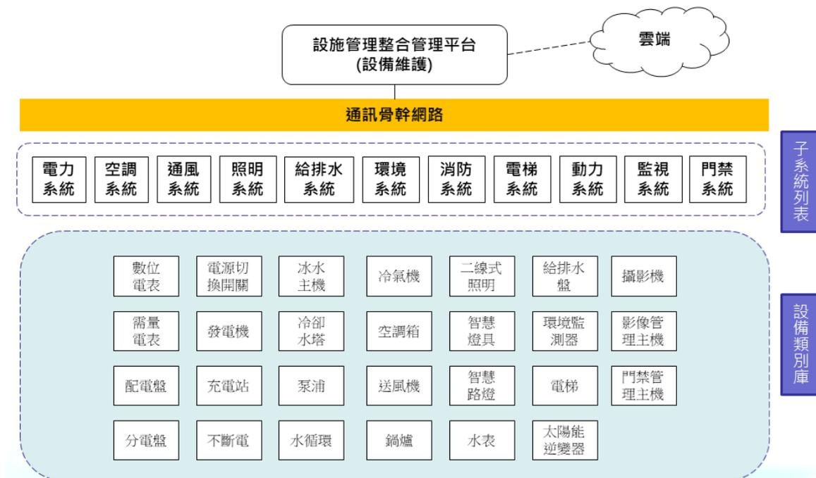
圖 1 設施管理整合管理平台所包含設備類別示意圖
