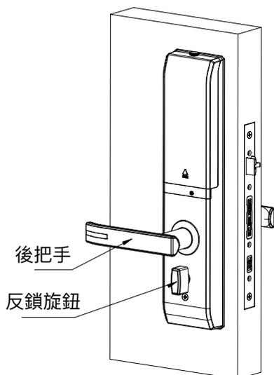
轉動前後把手和反鎖旋鈕，插入機械鑰匙，檢查個元件是否連結順暢完好，檢查貓眼開關開啟時，把手空轉，關時可以控制鎖體。
