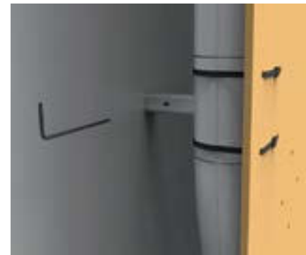
6. Particolare del fissaggio dei perni a parete.
