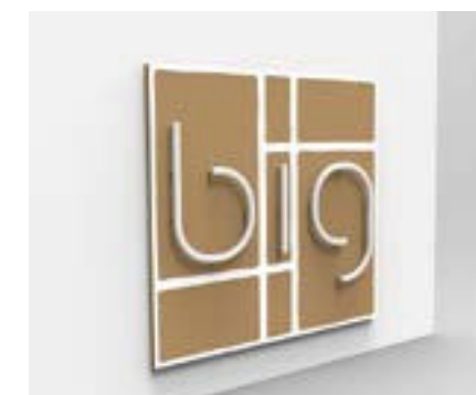
8. Posizionamento della garza e rasatura a filo delle intercapedini tra i pannelli.
