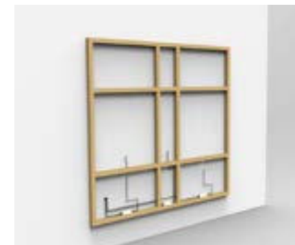
1. Creazione della struttura di supporto con predisposizione delle alimentazioni per le singole lettere.
