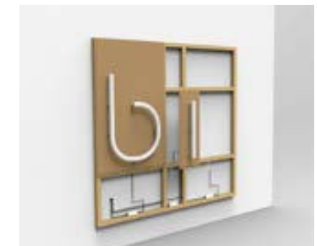
3. Fissaggio del pannello b e collegamento elettrico del pannello i.
