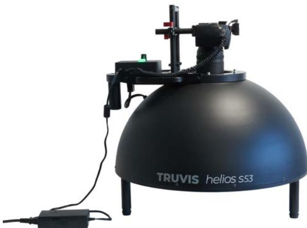
Abbildung 9: Aufgebauter Beleuchtungsdom ohne Lichtschutzmäntel
