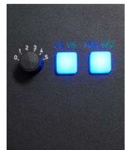
Hinweis: Um die UV-Belastung zu reduzieren, schalten sich die UV-LED's nach einer Minute automatisch aus und der Beleuchtungsdom wechselt in den VIS-SEQ-Modus. Um wieder in den UV-MOD-Modus zu gelangen, drücken Sie einfach einmal die UV-VIS-Taste.
