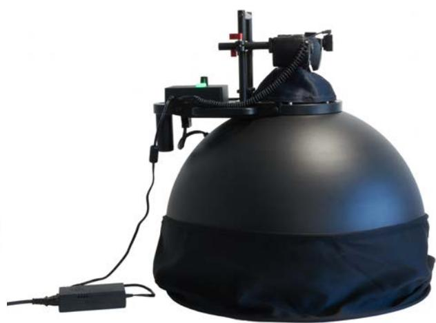
Abbildung 10: Aufgebauter Beleuchtungsdom mit Lichtschutzmäntel
