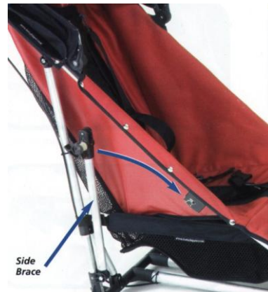
Kuva 4. Lukitse sivutuet painamalla putken päässä olevasta nastasta ja sovittamalla tuki paikoilleen. Varmista lukitus vielä kääntämällä varmistusvipu paikoilleen.
