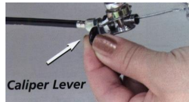
Kuva 5. Etupyörää kiinnitettäessä, vapauta etujarrua kääntämällä jarrussa oleva vipu ylä-asentoon. Palauta jarru, kun pyörä on kiinni.
