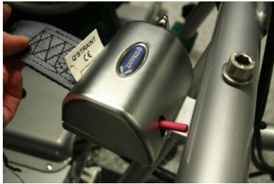
Kuvat 8 ja 9. Vapauta pyörätuolin kiinnitysremmi painamalla pinkkiä vipua ja kiinnitä remmit pyörätuolin runkoon (kaksi takana, yksi edessä) ja kiristä ratasta kääntämällä. Kiinnitä pyörätuolissa istuvan turvavyö.
