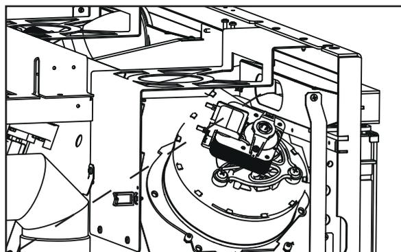
METTRE LE RACCORDEMENT À SA PLACE
