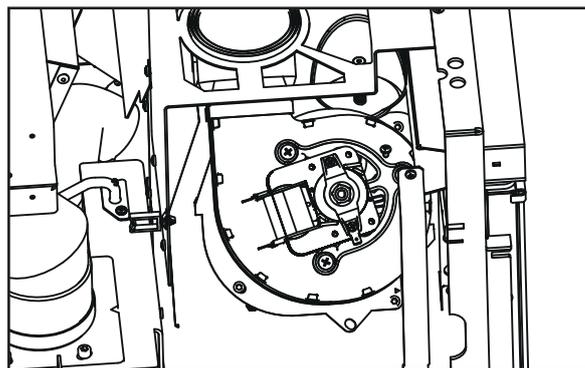
METTRE EN PLACE LE VENTILATEUR (A 45°) AVEC SONO JOIN ET LE VISSER
