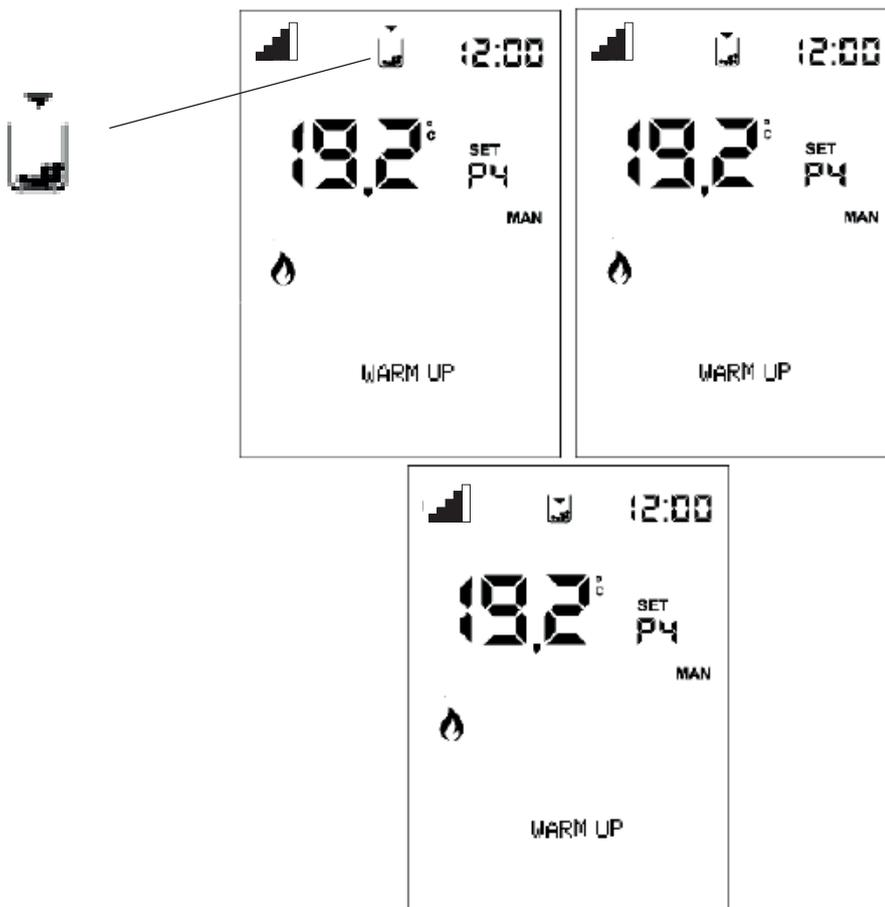
Les flèches s'allument séquentiellement, indiquant la nécessité de remplissage.
