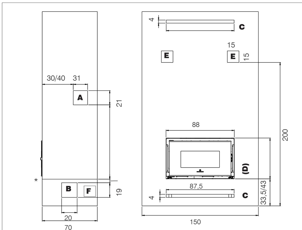
\* Ne pas dépasser la hauteur du socle avec le revêtement. Cela permet, lors de l'entretien, que le technicien fasse glisser le produit sur les rails.
