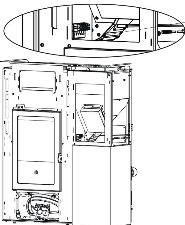
exemple borne de raccordement
