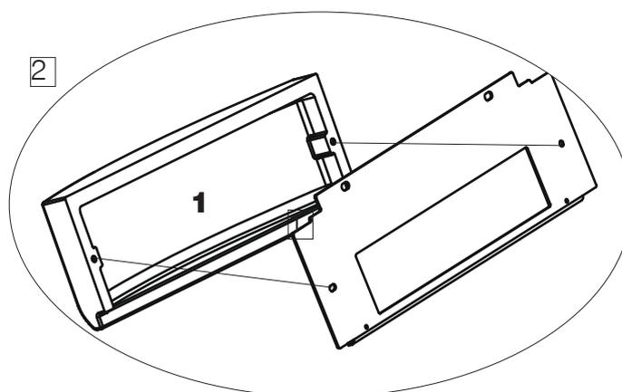
3. Visser la façade métallique inférieure - **1** (avec la façade inférieure en céramique montée) au poêle. Le réglage possible pour aligner la façade avant à la porte est droite/gauche, en tournant les vis dans les fentes.
