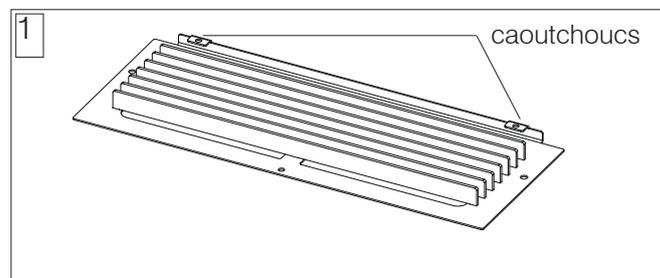
2. Placer la grille sous la céramique ou la pierre et la fixer avec les vis M4.
