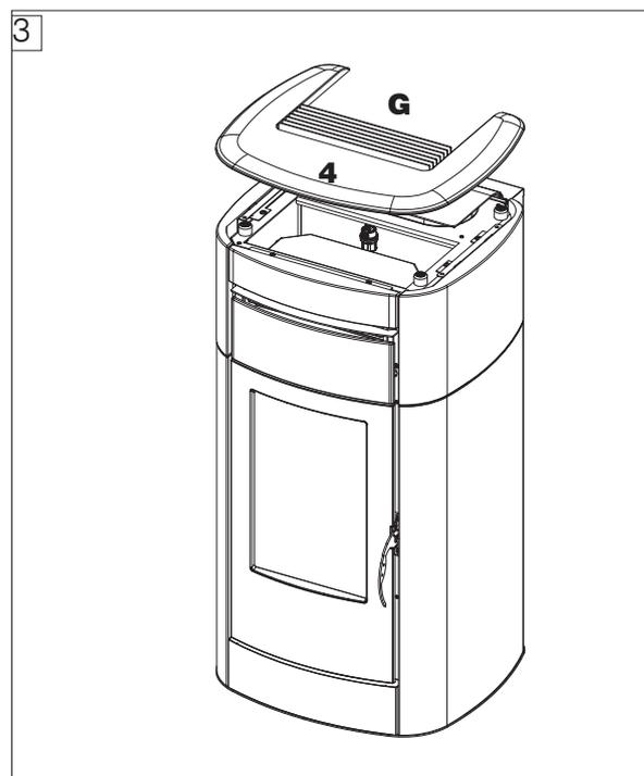
Les éventuels réglages peuvent être effectués en utilisant les pieds de support du dessus ou, comme indiqué dans le montage des flancs, en tournant les vis sous les flancs (avec le dessus et la partie latérale démontés).
