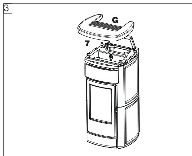
Les éventuels réglages peuvent être effectués en utilisant les pieds de support du dessus ou, comme indiqué dans le montage des parties latérales, en tournant les vis sous les parties latérales (avec le dessus et la partie latérale démontés).
