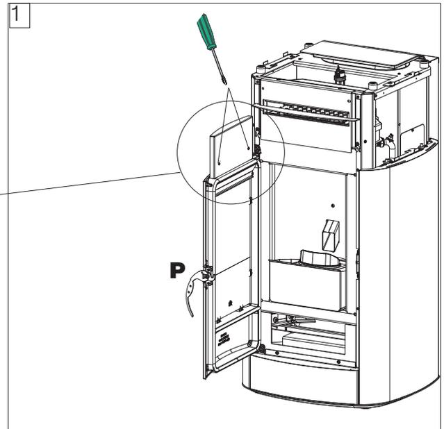
2. Dévisser les deux vis supérieures, insérer la façade (1) en céramique ou la pierre sur le support en métal au-dessus de la porte. Elle est fixée par encastrement sur les côtés et vissée dessus.
