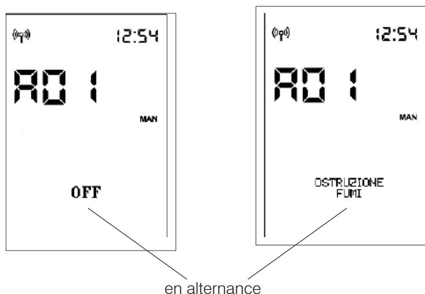
En cas d'alarme, le code d'alarme est affiché à la place de la température ambiante.
