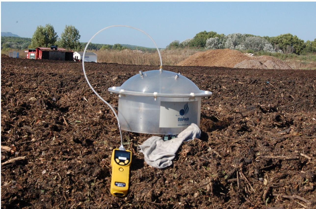
*Illustration 1: vue des méthodes de prélèvement sur les sources superficielles passives. Le prélèvement sur un andain en fermentation est conduit avec la chambre de flux. L'instrument jaune est un détecteur à photo-ionisation renseignant sur les teneurs en COV lors des phases de prélèvement.*
