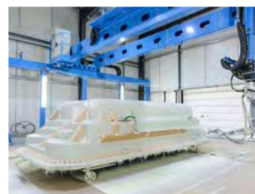
Pose des renforts + résine de protection
