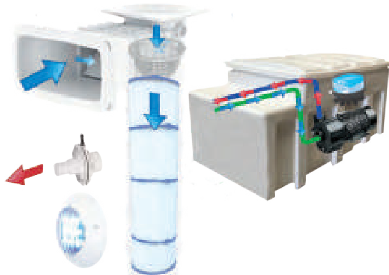
Schéma hydraulique de la paroi filtrante (standard hors options)
