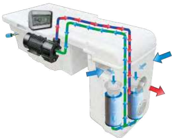
Schéma hydraulique du bloc filtrant (standard hors options)
