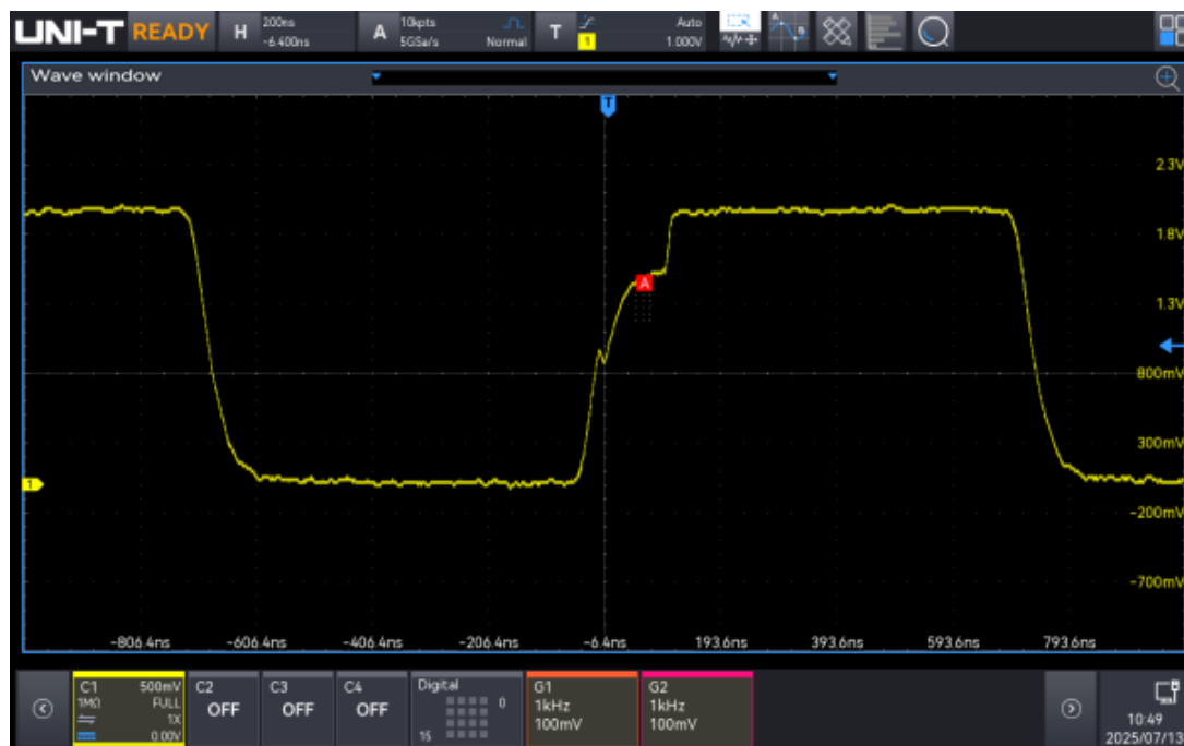
Non-monotonic edge signal
