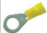
CODIGO 5580.917.004 TERMINAL ISOLADO OLHAL FURO M8 COBRE ESTANHADO FIO 4 A 6 MM AMARELO
