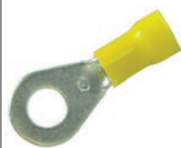
CODIGO 5580.916.004 TERMINAL ISOLADO OLHAL FURO M6 COBRE ESTANHADO FIO 4 A 6 MM AMARELO
