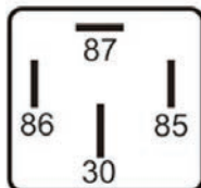
CODIGO 5510.011.001 REF 111 RELÉ AUXILIAR 12V 40A 4 TERMINAIS COM SUPORTE PARTIDA À FRIO, VELA INCANDESCENTE, DESEMBAÇADOR DO VIDRO TRASEIRO, VIDRO ELÉTRICO, MOTOR DE PARTIDA, BUZINA, BLOQUEADOR DE IGNIÇÃO, VENTILADOR DO RADIADOR, AR-CONDICIONADO, BOMBA ELÉTRICA DE COMBUSTÍVEL
