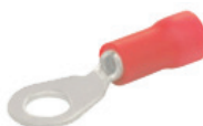
CODIGO 5580.901.003 TERMINAL ISOLADO OLHAL FURO M6 COBRE ESTANHADO CURTO FIO 0,5 X 1,5 MM VERMELHO
