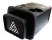
CODIGO 5590.210.003 REF 2103 INTERRUPTOR LUZ EMERGÊNCIA 8 TERMINAIS PRETO
