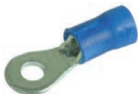
CODIGO 5580.906.004 TERMINAL ISOLADO OLHAL FURO M8 COBRE ESTANHADO CURTO FIO 1 X 2,5 MM AZUL
