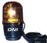
CODIGO 5510.400.009 REF 4009 LUZ ROTATIVA ADVERTÊNCIA LENTE ACRÍLICO E LÂMPADA DE 10W 12V / 0,9A AMBAR
