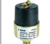
CODIGO 0250.600.613 ● SENSOR PRESSÃO AR M14 X 1,5 ESCALA 0 A 10 BAR ALARME 5,00 BAR SCANIA - T142 VOLVO - N.ORIG.360002008R
