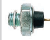
CODIGO 0250.400.002 ● INTERRUPTOR PRESSÃO DO ÓLEO * (N.F.) 0,14 - 0,41 BAR 1/8" X 27 NPTF CÔN N.ORIG.94.600.398
