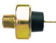
CODIGO 0250.100.002 INTERRUPTOR PRESSÃO DO ÓLEO * (N.F.) 0,15 - 0,45 BAR M 10 X 1 CÔN N.ORIG.021.919.081.B
