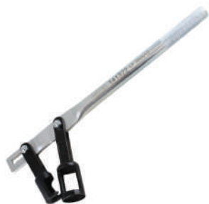
CODIGO: 9991.322.000 FERRAMENTA PARA COMPRIMIR AS MOLAS, DURANTE A DESMONTAGEM E MONTAGEM DAS VÁLVULAS DE MOTORES FIAT DE 1000 A 1600 8V (UNO, PALIO). USAR COM 141302 OU 141303
