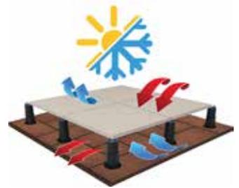
Die Luftschicht zwischen Boden und Platten sorgt für eine bessere Wärme- und Kälteisolierung.
