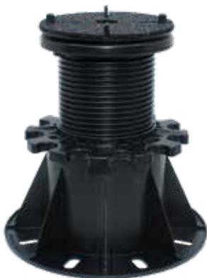
Wenn Stellfüße mit regulierbarem Kopf verbaut werden, müssen im Randbereich Stellfüße mit starrem Kopf (optional mit Anschlussplatte) eingesetzt werden.
