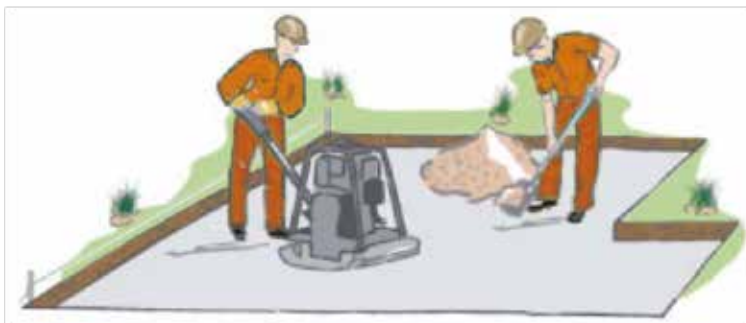
Tragschicht mit einem geeigneten Rüttler verdichten
