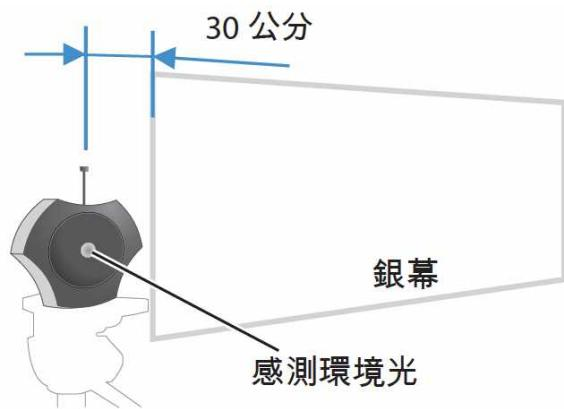
當測量間接光害的強度時，請將SpyderX設置於銀幕邊緣外30公分處，讓感測器不會直接接收到投影機發出來的光源，另外，請將SpyderX感測器面對投影機
