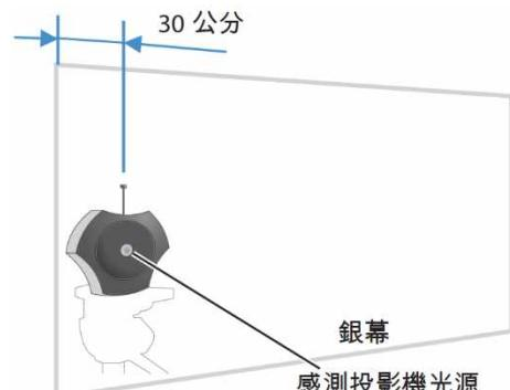
當測量投影機光源的強度時，請將SpyderX設置於銀幕邊緣內30公分處，讓感測器直接接收到投影機發出來的光源，另外，請將SpyderX感測器面對投影機
